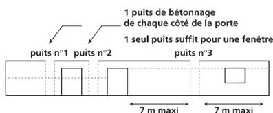
Remplir successivement les premiers compartiments par les puits 1 et 2 jusqu'à mi-hauteur afin de ne pas déséquilibrer les réservations sous l'effet de la pression exercée par le béton.
